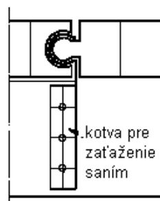
Obr. E5.4.1 Usporiadanie skúšky (schematicky) pre stanovenie vzájomného pôsobenia medzi ohybovým momentom a reakciou vnútornej podpery pri zaťaženiach saním pri jedno, alebo viacvrstvových paneloch so spojmi rovnobežne s rozpätím, všeobecne podľa ENV 1993-1-3 (EUROKÓD 3)
