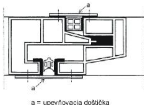
Obrázok 7: Príklad upevnenia spoja použitím doštičky
