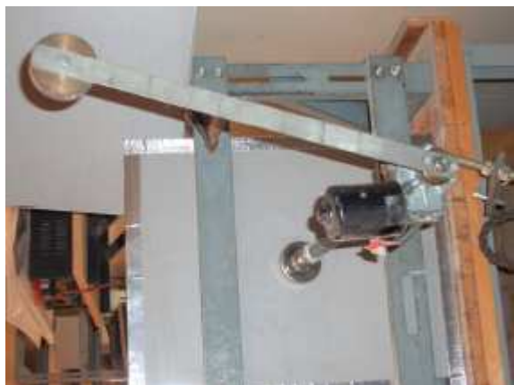
Obrázek 5. Zařízení pro zkoušení objímek na dynamickou zátěž
