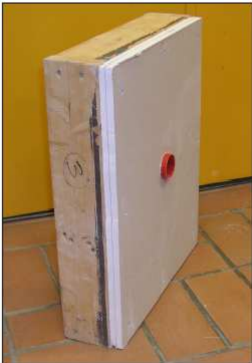
Obrázek 1. Zkušební vzorek dvou vrstev sádkartonu (13 mm) připevněných k ocelovému nebo dřevěnému rámu
