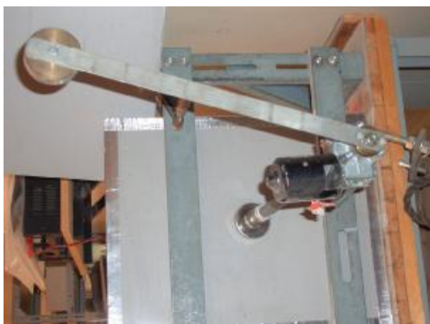
Obrázok 5. Zariadenie na skúšanie objímok pri dynamickom zaťažení.
