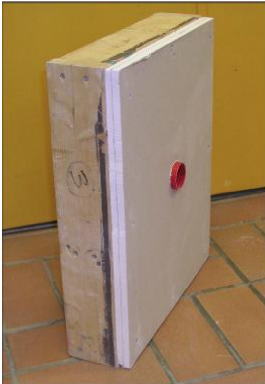
Obrázok 1. Skúšobný dielec pozostávajúci z dvoch vrstiev 13 mm sadrokartónu pripevnených k oceľovému alebo drevenému rámu.
