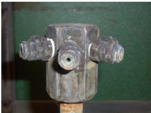
Obrázok 4. Trysky na striekanie vody.
